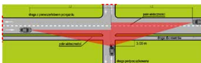
Rysunek 7 Odległość widoczności na skrzyżowaniach dróg z drogami dla rowerów z pierwszeństwem
