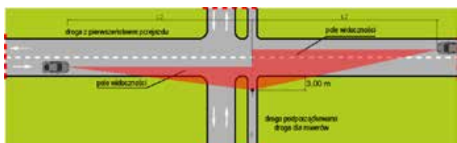
Rysunek 6 Odległość widoczności na skrzyżowaniach dróg z pierwszeństwem z drogami dla rowerów
